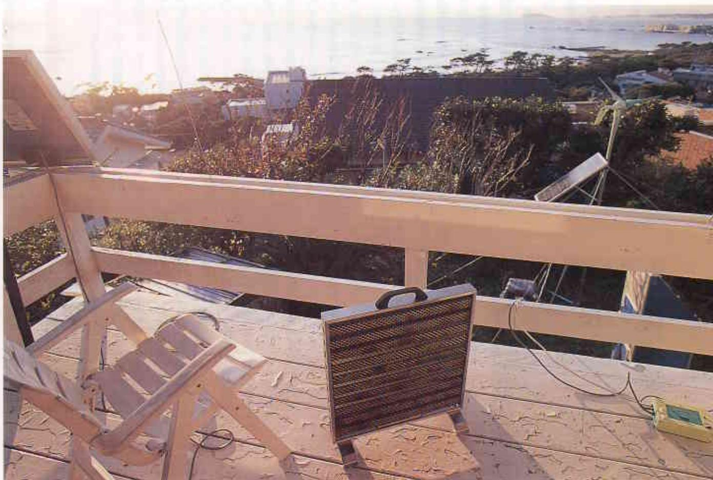
化学物質を使い捨てにせず、半永久的に使える非電化除湿機。湿気を吸うとピンクに変色するが、陽光に当て再生すれば再利用が可能だ。
